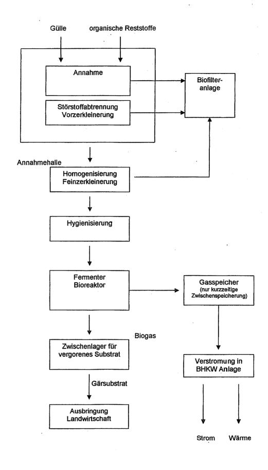
Bild 1: Fließschema einer Biogasanlage mit Kofermentation
